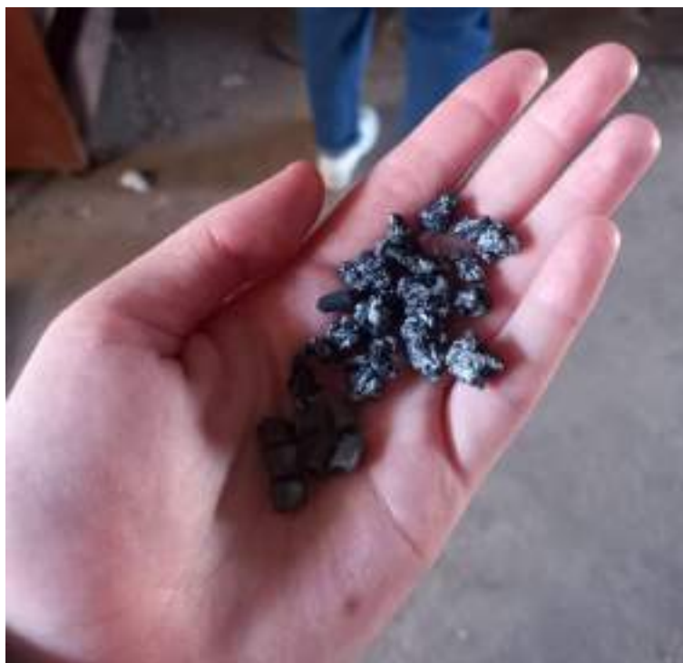
Fotografía 14. Agrumado de polietileno de baja densidad (coop. Todo Sirve).
